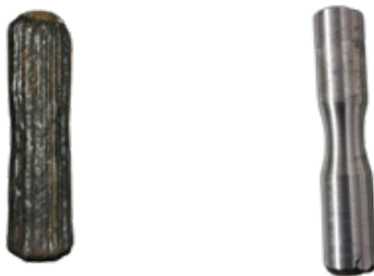
Hình 4. Mẫu thử sau khi chế tạo và gia công đúng tiêu chuẩn
