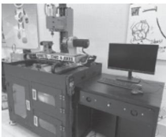
Hình 10. Hình ảnh máy khắc gỗ CNC 4 trục sau khi thiết kế chế tạo
