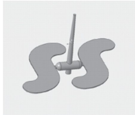
Hình 2. Mô phỏng phun ép sản phẩm
