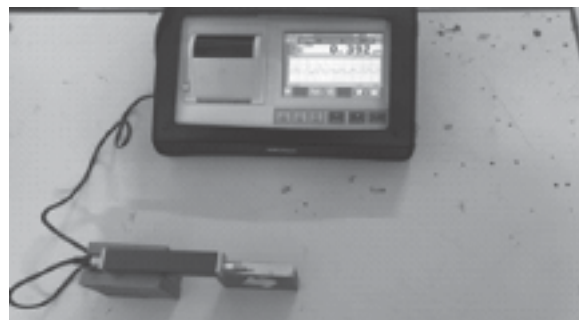
Hình 5. Đo bề mặt chi tiết sau khi gia công
