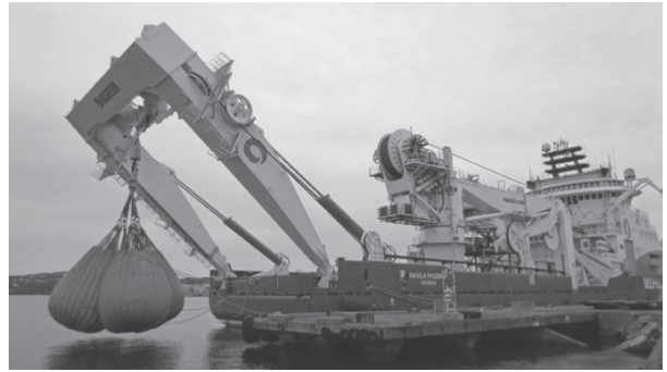
Hình 2. Kết cấu dạng khung cầu chữ A
