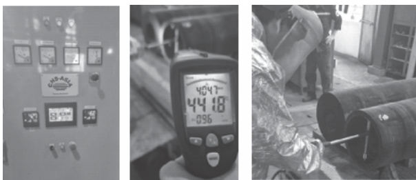
a) Lò nung b) Máy đo nhiệt độ c) Đồng hồ đo lỗ
