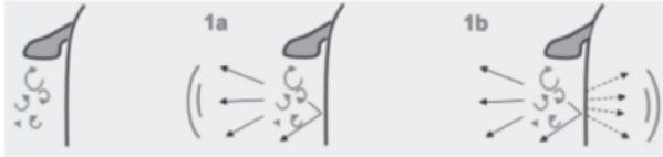
Hình 1. Sự hình thành âm khí động bên trong xe ô tô
